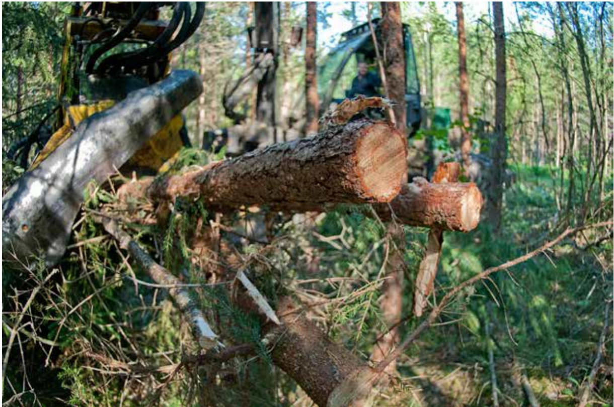
6. fotoattēls. Mežizstrādes darbus veic ar harvesteru, kas aprīkots ar papildus satvērējiem, lai vienlaikus varētu apstrādāt vairākus stumbrus (Foto: Erik Viklund)
