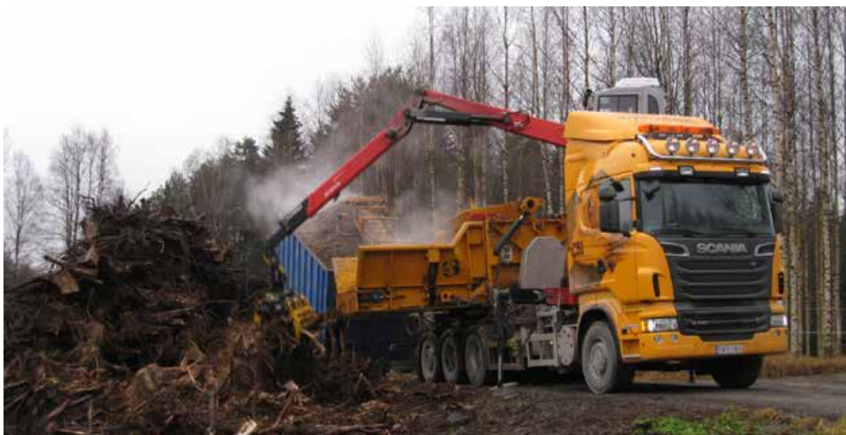
42. fotoattēls. Celmus pirms nogādāšanas siltumenerģijas ražotnēs sasmalcina uz vietas (Foto: Juha Laitila)
