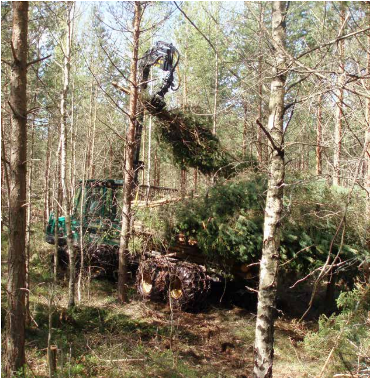
15. fotoattēls. Nedaudz zemāka krāvnēsība ir saistīta ar lielāku gaisa saturu nesagarumotu koku kravā zaru un mazo dimensiju koku dēļ (Foto: Maria Iwarsson Wide)
