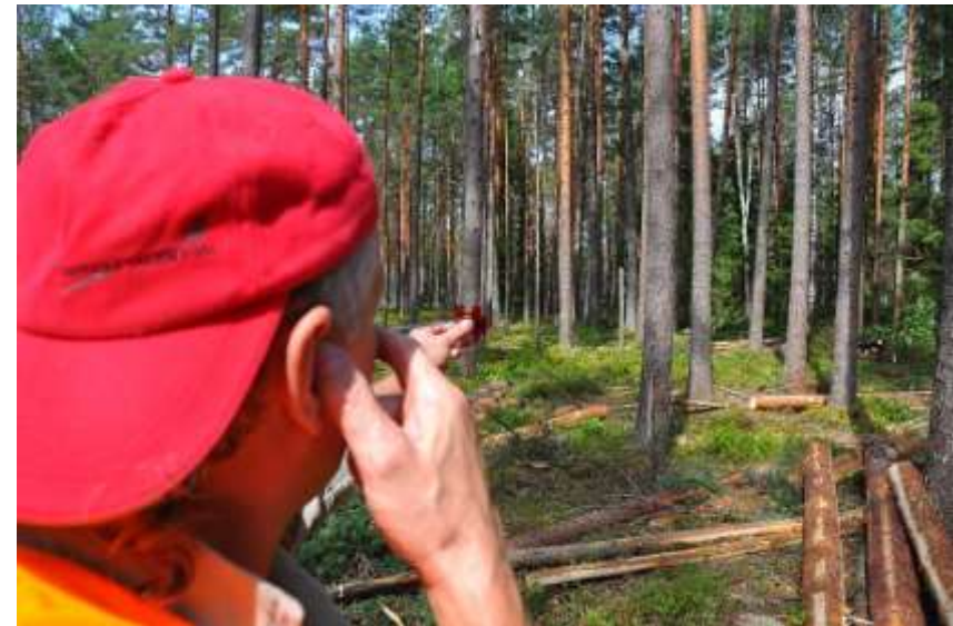
Šķērslaukuma mērīšana ar Biterliha relaskopu
